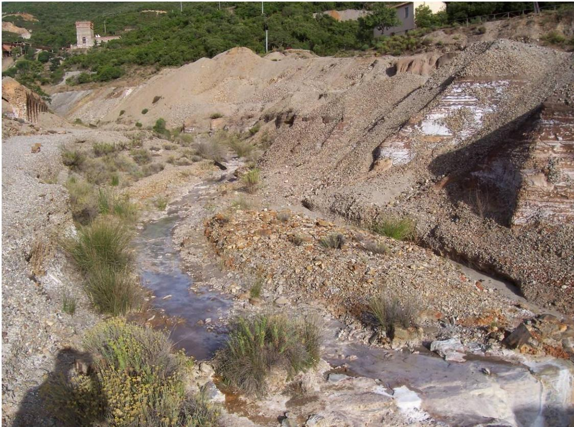
Nel cantiere sono presenti 33 discariche e 4 abbancamenti di materiali di trattamento mineralurgico, tra i quali particolarmente rilevante risulta l'abbancamento di fini lungo la vallata del Rio Sanna, a partire dall'impianto di trattamento. I materiali che le costituiscono sono di natura scistoso-quarzosa, con pezzame e
